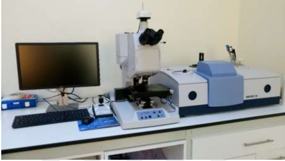
Şekil 3.2. Bruker Marka Vertex 70 model FTIR Spektrometresi
