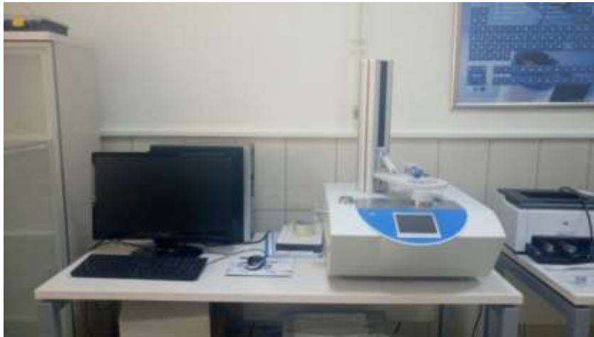
Şekil 3.3. Linseis STA PT1600 marka TGA cihazı
